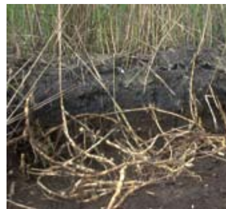
► Vue d'une coupe des boues déshydratées avec les racines des plans de roseaux (rhizomes)
